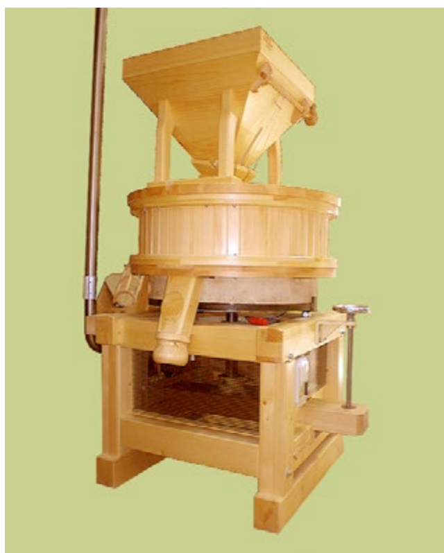
Sulla sinistra: Mulino con macine a pietra A 1000, resa 100 - 140 Kg/h con trasporto automatico Sulla destra: Decorticatrice mod NF-15P per l'asportazione della glumella dei chicchi dei cereali
